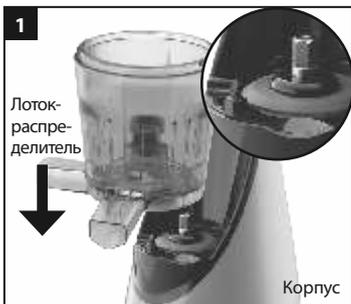
**Установите лоток-распределитель на корпус соковыжималки.**
